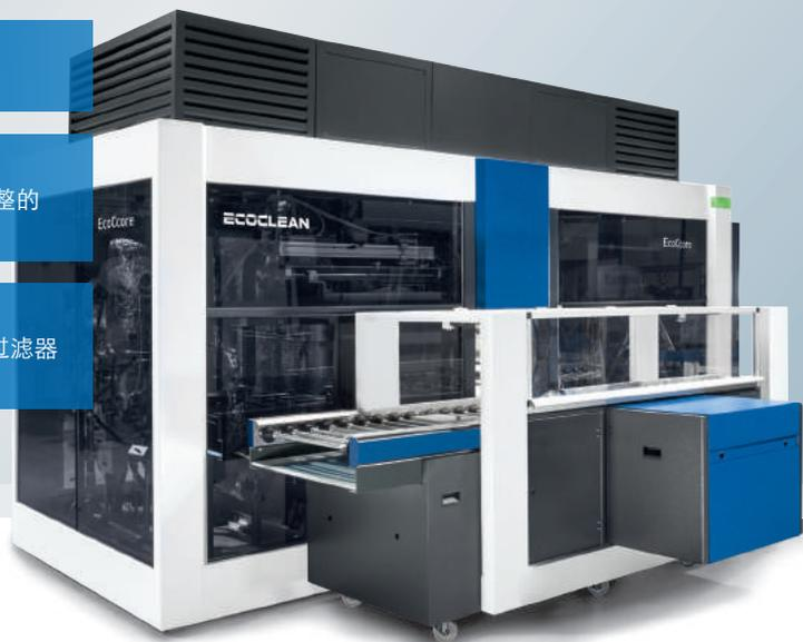
Ecoclean始终秉持着对高效及慎用资源方面的负责态度。能效优化的系统设有热能回收及降低溶剂损耗功能，通过对清洗介质的连续处理，我们的溶剂清洗系统持续性地缩短了工艺流程时间并降低了设备及单件清洗成本，且同时还保证了清洗质量时刻处于最高水平。
